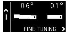
5. Wenn Sie mit den Ergebnissen des Nivellierens am Ende des Nivelliervorgangs nicht zufrieden sind, wählen Sie OK mit der Taste ►, wählen Sie dann die Option "**Finetune levelling**" und drücken Sie ►. Der XLifter startet den Feinabstimmungszyklus von der aktuellen Fahrzeugposition aus neu.
